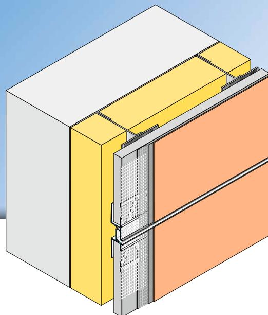
Il profilo per giunti **APU-Fugenprofil VHF-PRO-TEX** è utilizzato come raccordo al bordo delle lastre portanti nelle facciate di rivestimento retroventilate. Utilizzato insieme al profilo per giunti VHF-DROP-TEX (V82) permette la realizzazione di giunti di delimitazione di campo verticali e orizzontali, creando un bordo dell'intonaco pulito con distanza d'ombra.
