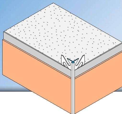
Il Profilo angolare **APU-Eckschutzwinkel DUO** è utilizzato nei sistemi di intonacatura per interni ed esterni per la realizzazione di bordi dell'intonaco precisi e a filo.
