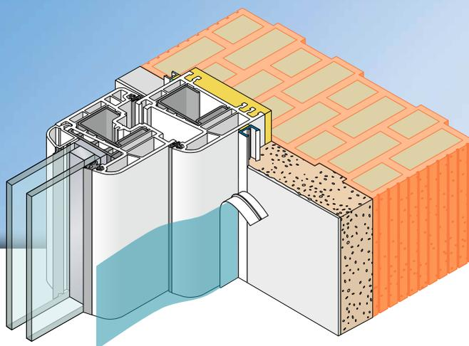
I profili per intonaco **APU-Anputzleiste MIDI** sono utilizzati nei sistemi di intonacatura per interni ed esterni in base agli attuali criteri di selezione di APU. Il profilo viene incollato nell'imbotte a filo con l'elemento architettonico di riferimento in modo da realizzare un raccordo netto e sicuro all'intonaco.
