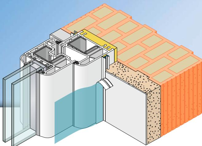
I profili per intonaco **APU-Anputzleiste MINI** sono utilizzati nei sistemi di intonacatura per interni ed esterni in base agli attuali criteri di selezione di APU. Il profilo viene incollato nell'imbotte allineato all'elemento architettonico di riferimento in modo da realizzare un raccordo netto e sicuro all'intonaco.
