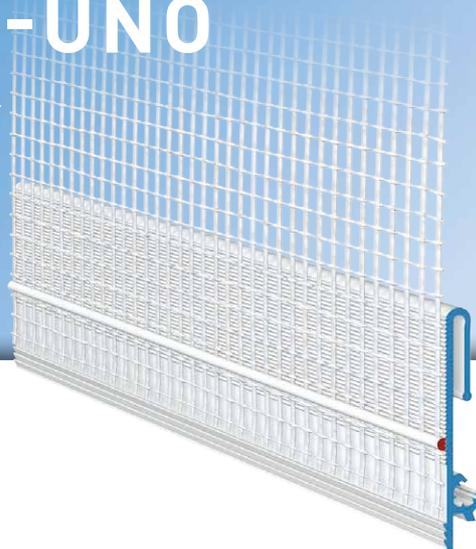
Il profilo di innesto zoccolo **APU REPO-TEX-UNO** si utilizza nei sistemi di isolamento a cappotto come chiusura su guide per zoccolatura in metallo a doccia o a T. In questo modo si compensano eventuali movimenti tra il raccordo a intonaco e il profilo metallico. Il profilo di innesto dello zoccolo UNO forma un bordo di intonacatura preciso e dritto.
