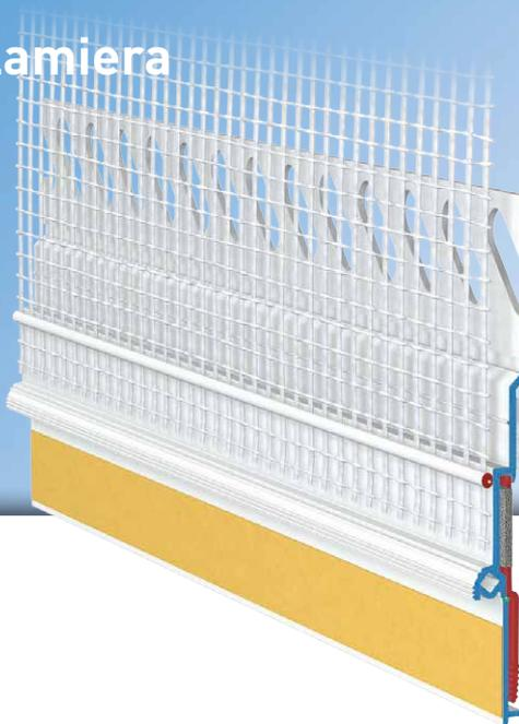
Il profilo di raccordo alla lamiera **APU-Blechanschlussprofil PUR- FIX** si installa sui raccordi alla lamiera (ad esempio lungo la scossalina) nei sistemi di isolamento a cappotto e consente di realizzare un collegamento mobile tra intonaco e lamiera grazie alla guarnizione in PUR integrata. Il profilo è utilizzato per uno spessore di intonaco di 8 mm e garantisce una eliminazione mirata dell'acqua una volta completata l'intonacatura.
