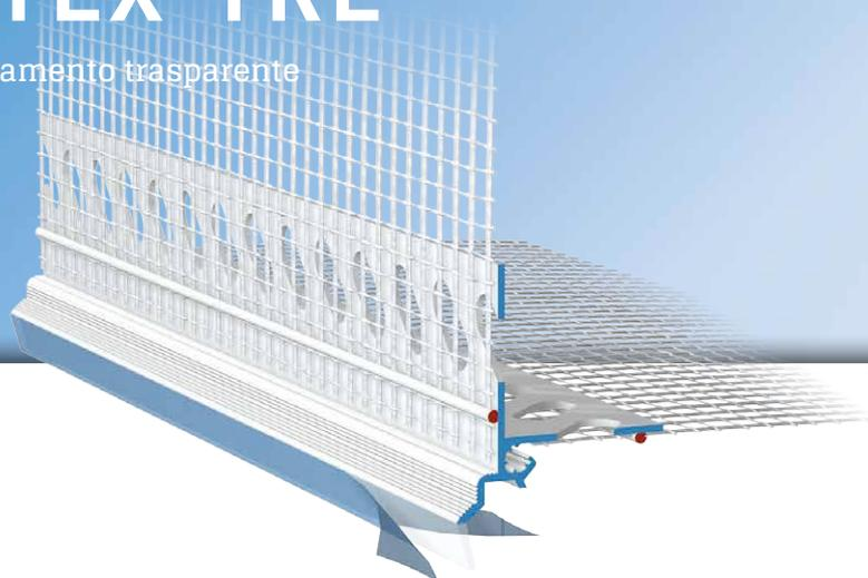
Il profilo di chiusura **APU-Abschlussprofil DROP-TEX-TRE** viene inserito orizzontalmente nei sistemi di isolamento a capotto in corrispondenza di elementi incassati, ad esempio le imbotti di porte e finestre. Il bordo inclinato del profilo con bordo di gocciolamento trasparente rappresenta una soluzione sicura per convogliare l'acqua verso il basso.
