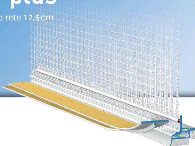
Il profilo con rete **APU-Gewebeleiste MILANO-plus** è utilizzato nei sistemi di isolamento termico a cappotto secondo le indicazioni di applicazione APU. Il profilo viene incollato nell'imbotte a filo con l'elemento architettonico di riferimento in modo da realizzare un raccordo netto e sicuro all'intonaco una volta installato.
