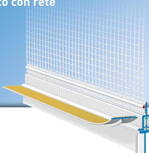
Il **profilo telescopico con rete APU-Teleskop-Gewebeleiste IDEAL-R** è utilizzato nei sistemi di isolamento termico a cappotto secondo le indicazioni di applicazione APU. Il profilo viene incollato nell'imbotte ai lati delle guide degli avvolgibili in modo da realizzare un raccordo netto e sicuro all'intonaco una volta completati i lavori di intonacatura.
