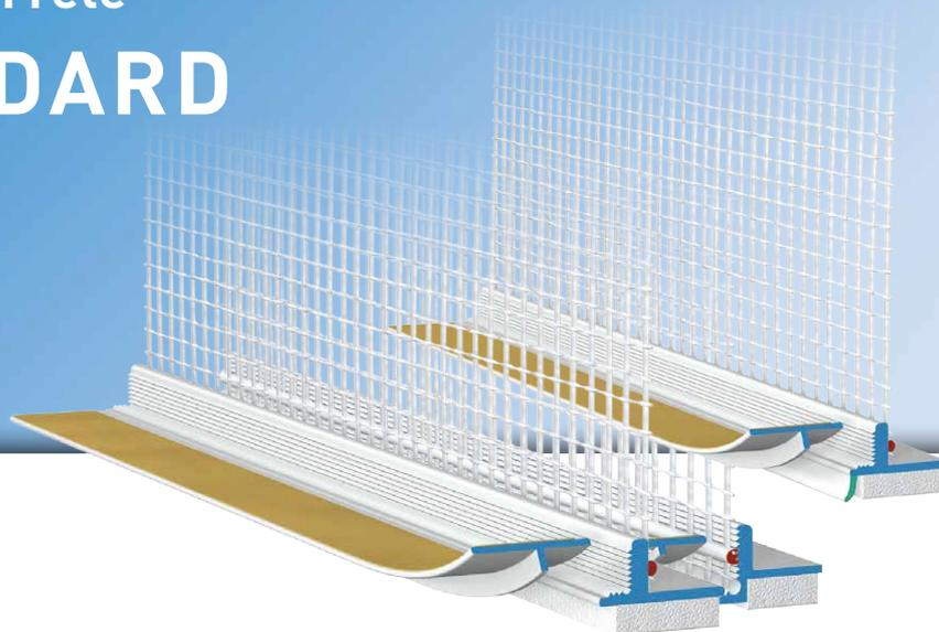
Il profilo con rete **APU-Gewebeleiste STANDARD** è utilizzato nei sistemi di isolamento termico a cappotto secondo le indicazioni di applicazione APU. Il profilo viene incollato nell'imbotte a filo con l'elemento architettonico di riferimento in modo da realizzare un raccordo netto e sicuro all'intonaco.
