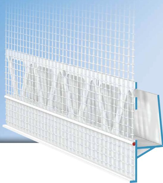
Il profilo per giunti **APU-Fugenprofil VHF-DROP-TEX** è utilizzato come raccordo al bordo delle lastre portanti nelle facciate di rivestimento retroventilate. Utilizzato insieme al profilo per giunti VHF-PRO-TEX (V83) permette la realizzazione di giunti di delimitazione di campo verticali e orizzontali, creando un bordo dell'intonaco pulito con distanza d'ombra.
