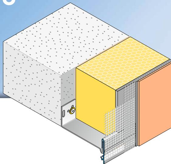
Le rail de départ **REPO-TEX-UNO d'APU** est utilisé dans les systèmes d'ITE comme arrêt sur des rails de départ métalliques en forme de creux ou de T. Le profilé de soubassement clipsable UNO forme une arête d'enduit parfaite et droite. La goutte d'eau créée assure une évacuation précise de l'eau. Une bande de trame est soudée au profilé. Chaque longueur dispose d'un débord de trame
