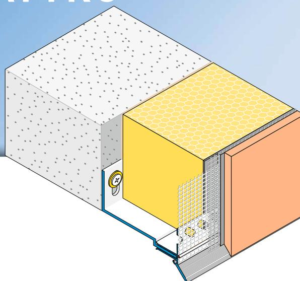
Le rail de départ **SOLI-TEX-QUATTRO d'APU** est utilisé dans les systèmes d'ITE comme arrêt inférieur de l'isolation du mur.
