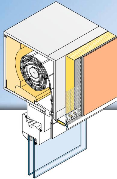
Le profilé de jonction horizontale prêt à coller **APU ZERO** est posé à l'horizontale dans les systèmes d'isolation thermique par l'extérieur, pour des jonctions pour des jonctions d'enduit par ex. avec des coffrages de volet roulant. L'angle du profilé avec brise-goutte apparent visible offre une solution fiable pour diriger l'eau vers le bas.
