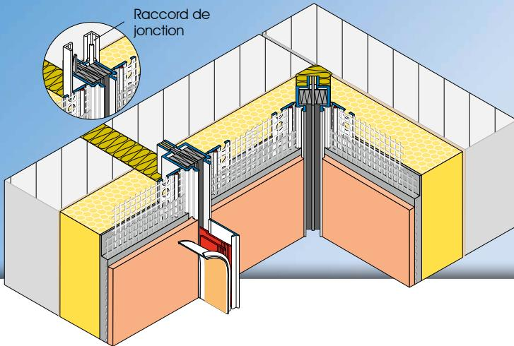
Le profilé pour **joint de dilatation APU PUR-FIX** est utilisé dans les systèmes composites d'isolation thermique pour les joints verticaux des bâtiments. Le profilé peut être utilisé sur la surface ainsi que dans l'angle intérieur pour la réalisation d'un bord de crépi propre et parfaitement aligné.
