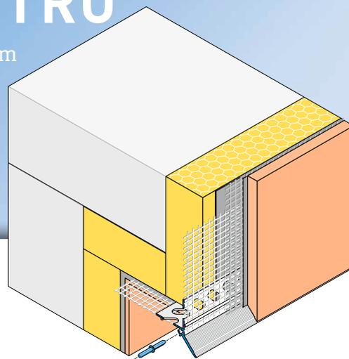
Le profilé d'arrêt **DROP-TEX-TRE d'APU** est utilisé horizontalement dans les systèmes d'isolation thermique par l'extérieur pour les parties du bâti en retrait comme par ex. les tableaux de fenêtre et de porte. La forme inclinée du profilé pour enduit gratté offre une solution fiable concernant les descentes d'eau.
