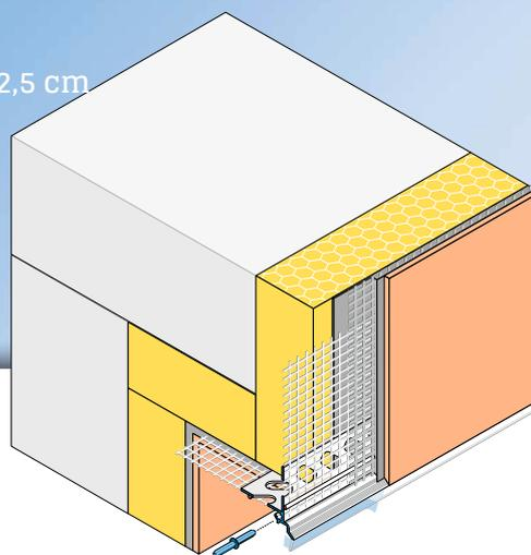
Le profilé d'arrêt **DROP-TEX-TRE d'APU** est utilisé horizontalement dans les systèmes d'isolation thermique par l'extérieur pour les parties du bâti en retrait comme par ex. les tableaux de fenêtre et de porte. La forme coudée du profilé avec une goutte d'eau transparente offre une solution fiable concernant les descentes d'eau.
