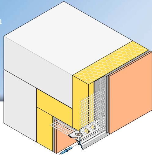
Le profilé d'arrêt **DROP-TEX-DUE d'APU** est utilisé horizontalement dans les systèmes d'isolation thermique par l'extérieur pour les parties du bâti en retrait comme par ex. les tableaux de fenêtre et de porte. La forme coudée du profilé offre une solution fiable concernant les descentes d'eau.
