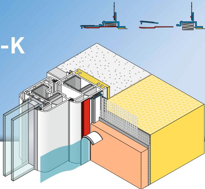
La baguette pré-entoilée **PUR-FIX-pro-K** est utilisée dans les systèmes d'isolation thermique par l'extérieur selon les critères de sélection APU en vigueur. Le profilé doit être rapporté juste avant l'isolation du tableau, fixé de manière rectiligne au support et offre, une fois les travaux d'enduisage terminés, un arrêt d'enduit sûr et propre avec joint creux. Le profilage permet l'application aussi bien d'enduit épais que d'enduit gratté.
