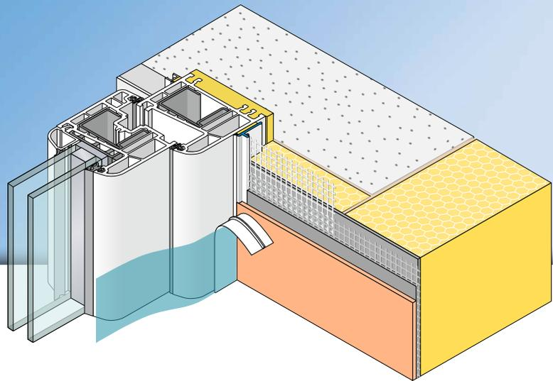
La baguette pré-entoilée **STANDARD-UV d'APU** est mise en œuvre dans les systèmes d'ITE selon les domaines d'application définis par APU. Le profilé est collé au support de manière rectiligne au niveau du tableau, formant ainsi un arrêt d'enduit propre et sûr avec joint creux.
