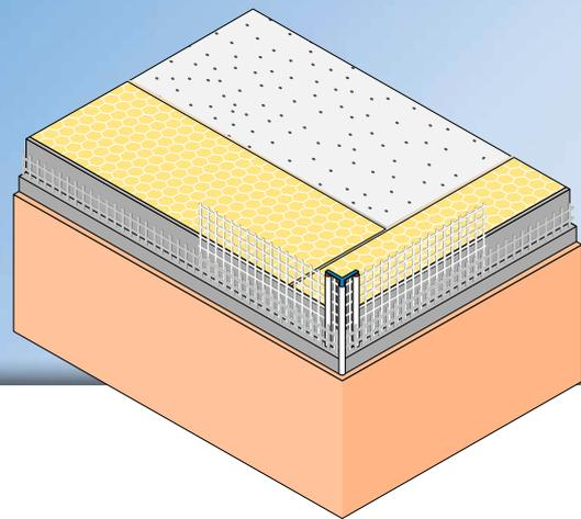
La cornière pré-entoilée **TOP-TEX d'APU** est mise en œuvre en ITE en tant qu'arête rectiligne et résistante aux chocs pour les enduits minces de Fond. En cas de besoin, sa souplesse la rend parfaitement adaptée aux arrondis.
