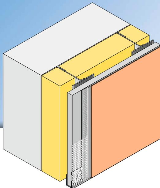
Le profilé à emboîter **APU VHF-FIN-TEX** est utilisé pour les bardages suspendus et ventilés par l'arrière comme élément d'arrêt au bord de la plaque de support.
