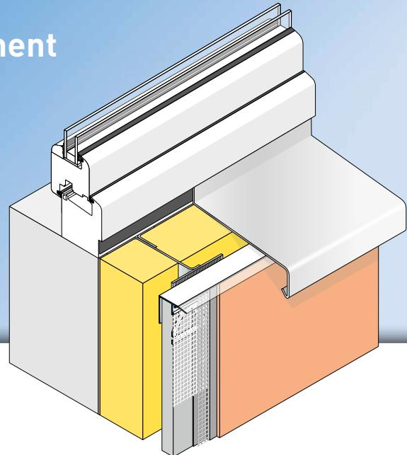
Le profilé clipsable **APU VHF-TOP-TEX** est utilisé pour les bardages suspendus et ventilés par l'arrière, sur le bord supérieur de la plaque de support au niveau de l'acrotère ou sous l'appui de fenêtre.
