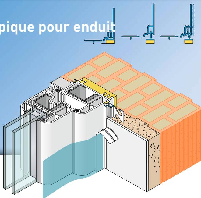
Le profilé d'arrêt **FLEX** « télescopique » **d'APU** est destiné aux systèmes d'enduit en intérieur et en extérieur selon les spécifications actuelles d'APU. Le profilé est collé sur le tableau au droit de la structure en place et constitue ainsi un arrêt d'enduit propre et sûr.
