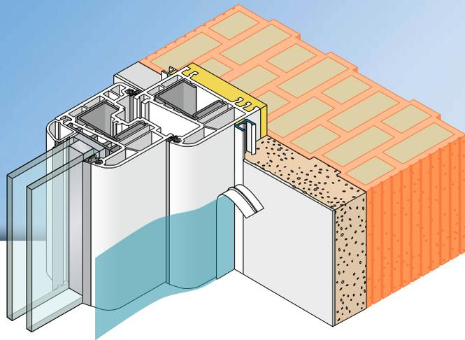
Le profilé d'arrêt **APU-MIDI** est mis en œuvre dans les systèmes d'enduit en intérieur et extérieur selon les spécifications actuelles d'APU. Le profilé est collé sur le tableau au droit du support en place et constitue ainsi un arrêt d'enduit propre et sûr. Le profilé a une largeur de 12mm et est équipé d'une bande de mousse autocollante en PE qui assure une étanchéité durable et aux fortes pluies.
