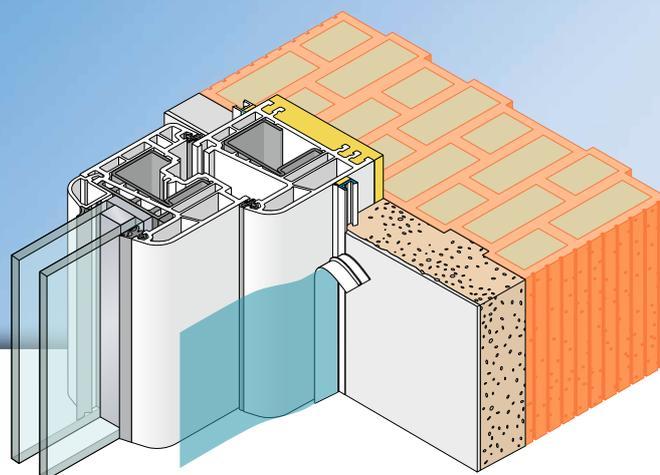
Le profilé d'arrêt **APU-MINI** est mis en oeuvre dans les systèmes d'enduit en intérieur et extérieur selon les spécifications actuelles d'APU. Le profilé est collé sur le tableau au droit de la structure en place et constitue ainsi un arrêt d'enduit propre et sûr. Le profilé a une largeur de 9 mm et est équipé d'une bande de mousse autocollante en PE qui assure une étanchéité durable et aux fortes pluies.
