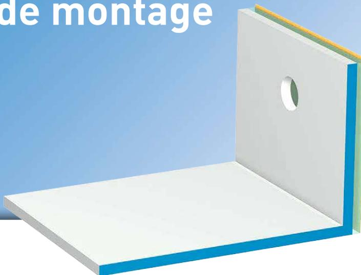
L'**équerre de montage d'APU** est mise en œuvre au niveau du soubassement comme outil de montage pour l'isolation de mur. Si l'isolation périmétrique est rapportée ultérieurement, les panneaux d'isolation murale doivent venir s'appuyer sur les équerres de montage autocollantes ( 2ex./ml). L'équerre existe en deux épaisseurs différentes : 60 et 120 mm.
