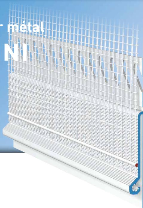
Le profilé de liaison sur métal **FIN-TEX MINI d'APU** est utilisé comme profilé de liaison (par ex. au niveau du solin) dans les systèmes ITE et permet une liaison mobile entre l'enduit et le métal grâce à sa cavité. Le profilé est prévu en épaisseur de 8 mm et veille à la fin des travaux d'enduisage à une évacuation parfaite de l'eau.
