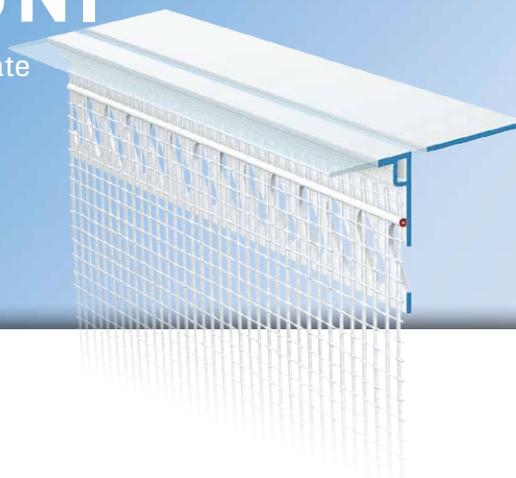
Le profilé d'arrêt **FEBA-TEX-UNI d'APU** est utilisé dans les systèmes d'isolation thermique par l'extérieur. Par la mise en œuvre d'une seconde plage d'étanchéité il assure un arrêt propre sous l'appui-fenêtre.
