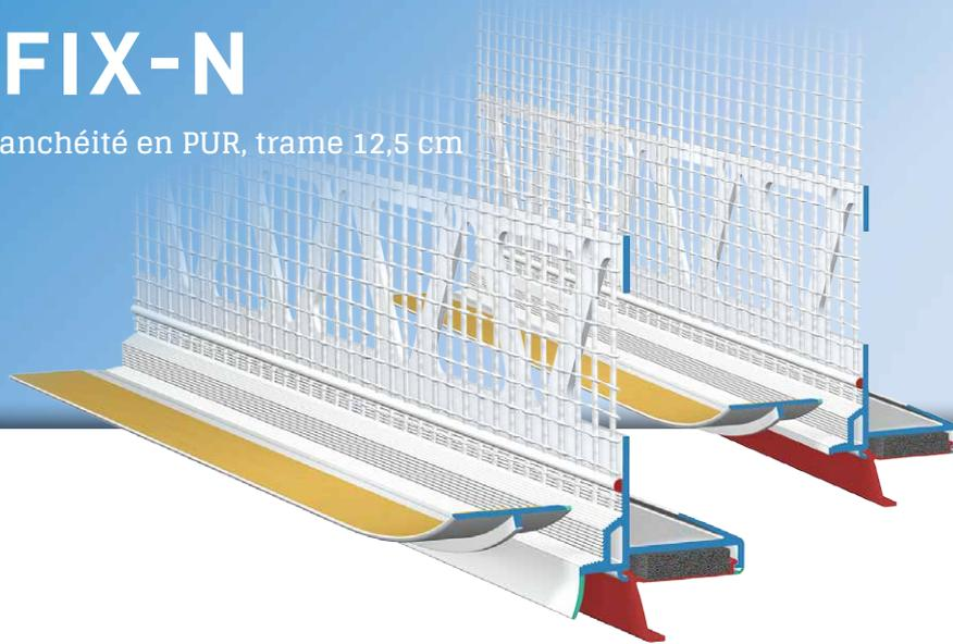
La baguette pré-entoilée **PUR-FIX-N-plus d'APU** est mise en œuvre dans les systèmes d'ITE selon les domaines d'application définis par APU. Après ouverture de la languette d'activation rouge dans l'isolation du tableau, fixer le profilé, à l'aide des clous en plastique (Z21) joints, à environ 2mm du support dans l'isolant.
