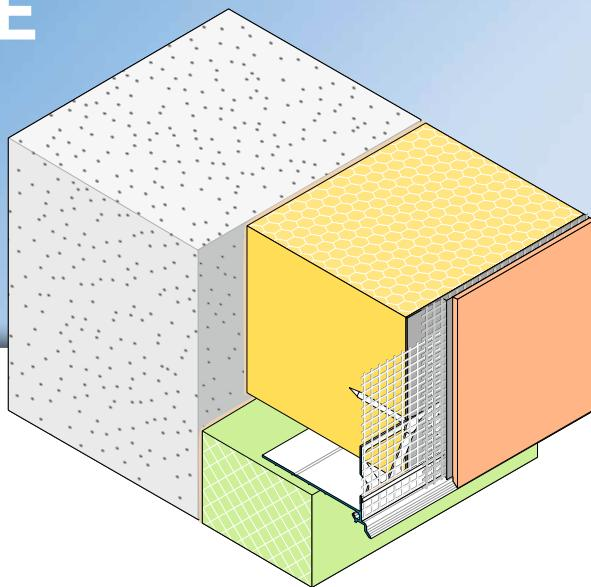
El **perfil de borde de zócalo APU SOKA-FIX-DUE** se utiliza en sistemas compuestos de aislamiento térmico como acabado inferior del aislamiento de pared.
