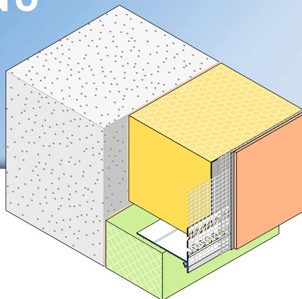
El **perfil de borde de zócalo APU SOKA-TEX-UNO** se utiliza en sistemas compuestos de aislamiento térmico como acabado inferior del aislamiento de pared.
