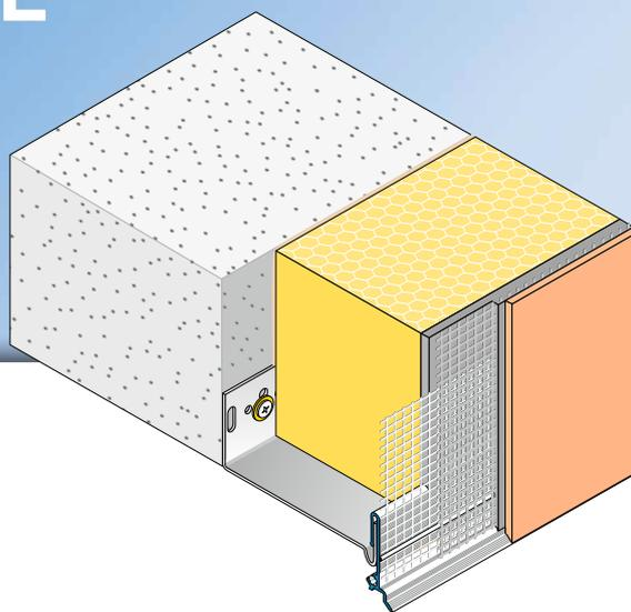
El **perfil encajable de zócalo APU REPO-TEX-DUE** se utiliza en sistemas compuestos de aislamiento térmico como acabado sobre rieles de zócalo metálicos con forma de artesa o en «T». De este modo se compensan los movimientos entre la unión del revoque y el perfil metálico. El perfil encajable de zócalo DUE forma un borde del revoque exacto.
