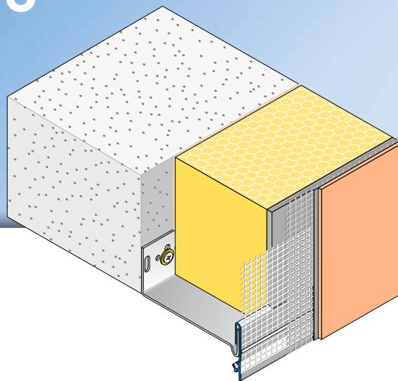
El **perfil encajable de zócalo APU REPO-TEX-UNO** se utiliza en sistemas compuestos de aislamiento térmico como acabado sobre rieles de zócalo metálicos con forma de artesa o en «T». De este modo se compensan los movimientos entre la unión del revoque y el perfil metálico. El perfil encajable de zócalo UNO forma un borde del revoque recto exacto.
