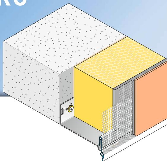
El **perfil encajable de zócalo APU REPO-TEX-ZERO** se utiliza en sistemas compuestos de aislamiento térmico como acabado sobre rieles de zócalo metálicos con forma de artesa o en «T». De este modo se compensan los movimientos entre la unión del revoque y el perfil metálico. El perfil encajable de zócalo ZERO forma un borde del revoque exacto con goterón.
