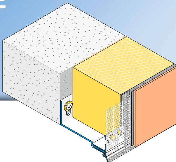
El **riel de zócalo APU SOLI-TEX-DUE** se utiliza en sistemas compuestos de aislamiento térmico como acabado inferior del aislamiento de pared.
