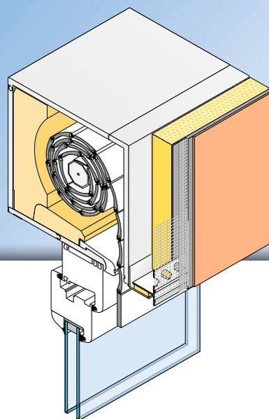
Il profilo per incollaggio **APU-Aufklebeprofil UNO** viene inserito orizzontalmente nei sistemi di isolamento a capotto, ad esempio nei raccordi dell'intonaco alle scatole degli avvolgibili.
