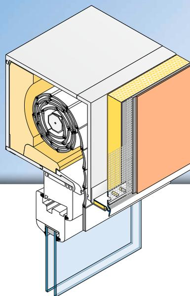
Il profilo per incollaggio **APU-Aufklebeprofil ZERO** viene inserito orizzontalmente nei sistemi di isolamento a capotto, ad esempio nei raccordi dell'intonaco alle scatole degli avvolgibili.
