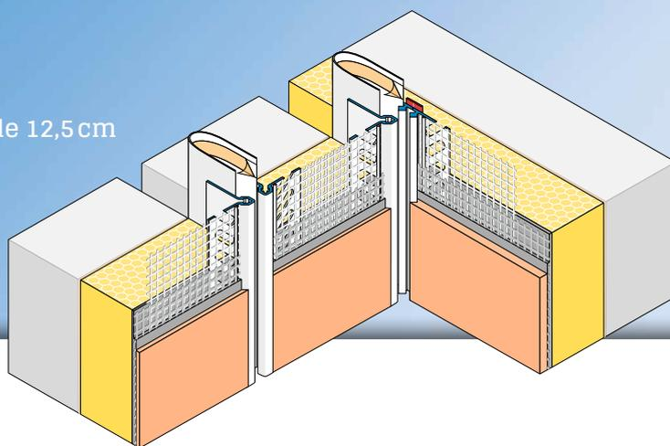
El **perfil para juntas de dilatación APU DUO-TEX** se utiliza en sistemas compuestos de aislamiento térmico en juntas de edificio. Para la formación enrasada de un borde del revoque limpio se producen perfiles para superficie (W52) y para esquina interior (W51).
