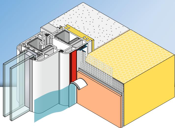
El **perfil de remate con malla APU PUR-FIX-pro** se utiliza en sistemas compuestos de aislamiento térmico conforme a los criterios de selección actuales de APU. El perfil se fija enrasado poco antes del aislamiento del intradós sobre el componente y ofrece una conexión de revoque con junta de sombra segura y limpia una vez finalizados los trabajos de revoque.
