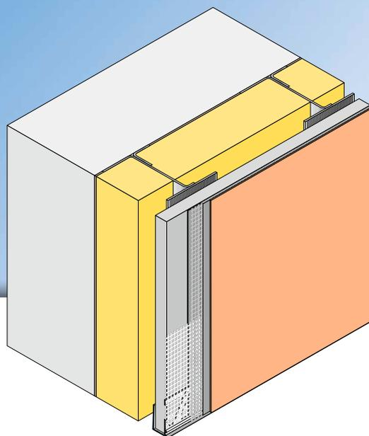
El **perfil encajable APU VHF-FIN-TEX** se utiliza en fachadas ventiladas como remate sobre el borde del panel portante.
