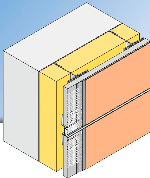
**El perfil de juntas APU VHF-PRO-TEX** se utiliza en fachadas ventiladas como remate sobre el borde del panel portante. En conexión con el perfil de juntas VHF-DROP-TEX (V82) se forma de este modo la junta de partición en horizontal y vertical y se crea un borde del revoque limpio con junta de sombra.
