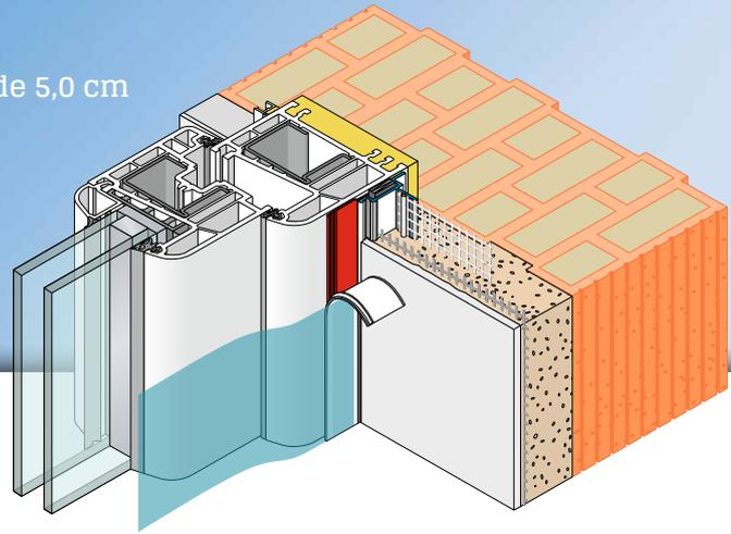
El **perfil de remate de revoque APU PUR-FIX-pro** se utiliza en sistemas de revoque en interiores y exteriores conforme a los criterios de selección actuales de APU. El perfil se fija enrasado en el intradós sobre el componente y forma una conexión de revoque con junta de sombra segura y limpia con junta de sombra una vez finalizados los trabajos de revoque.
