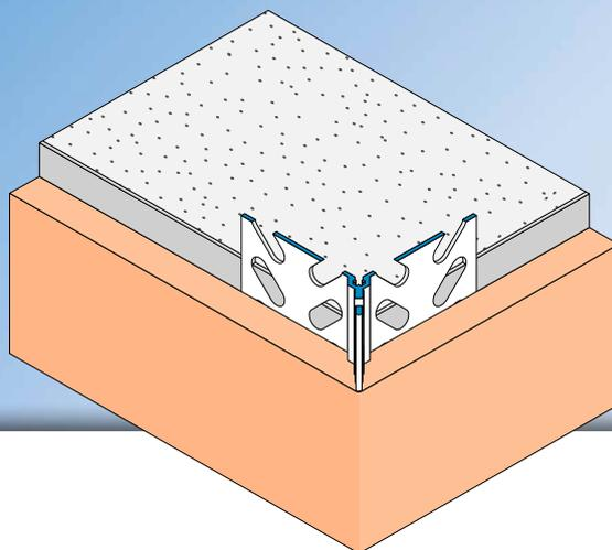
El **esquinero APU STABILO** se utiliza en sistemas de revoque en interiores y exteriores para la formación de un borde de revoque enrasado y exacto.
