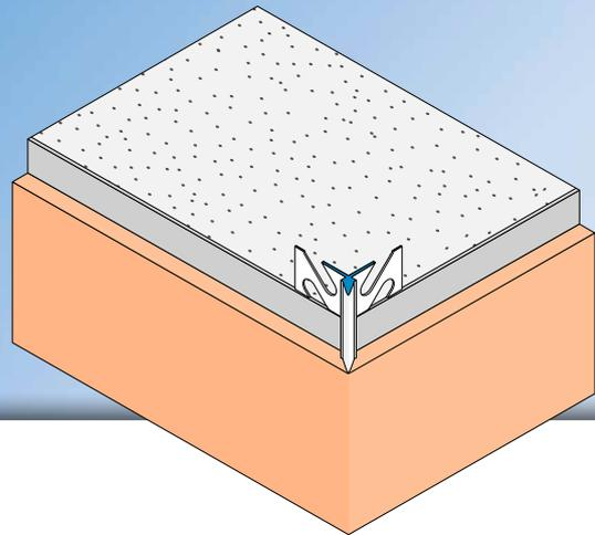
La **cantonera APU DUO** se utiliza en sistemas de revoque en interiores y exteriores para la formación de un borde de revoque enrasado y exacto.
