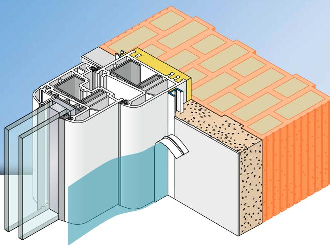
El **perfil de remate de revoque APU MIDI** se utiliza en sistemas de revoque en interiores y exteriores conforme a los criterios de selección actuales de APU. El perfil se pega enrasado en el intradós sobre el componente existente y forma de este modo un acabado del revoque seguro y limpio.
