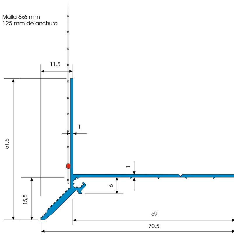
Dibujo seccional en mm
