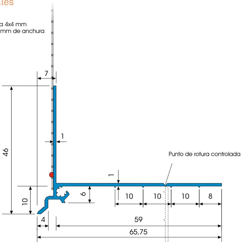
Dibujo seccional en mm
