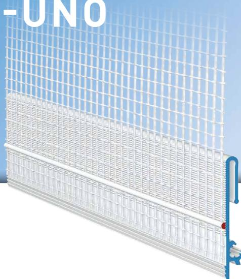
El **perfil encajable de zócalo APU REPO-TEX-UNO** se utiliza en sistemas compuestos de aislamiento térmico como acabado sobre rieles de zócalo metálicos con forma de artesa o en «T». De este modo se compensan los movimientos entre la unión del revoque y el perfil metálico. El perfil encajable de zócalo UNO forma un borde del revoque recto exacto.
