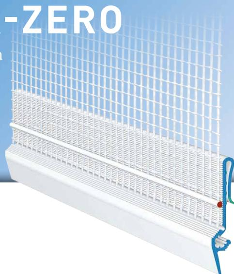
El **perfil encajable de zócalo APU REPO-TEX-ZERO** se utiliza en sistemas compuestos de aislamiento térmico como acabado sobre rieles de zócalo metálicos con forma de artesa o en «T». De este modo se compensan los movimientos entre la unión del revoque y el perfil metálico. El perfil encajable de zócalo ZERO forma un borde del revoque exacto con goterón.
